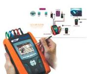
Um lange Messleitungen zu vermeiden, wird beim Solar 300N ein kabelloser Messwertsensor Solar-02 eingesetzt.
