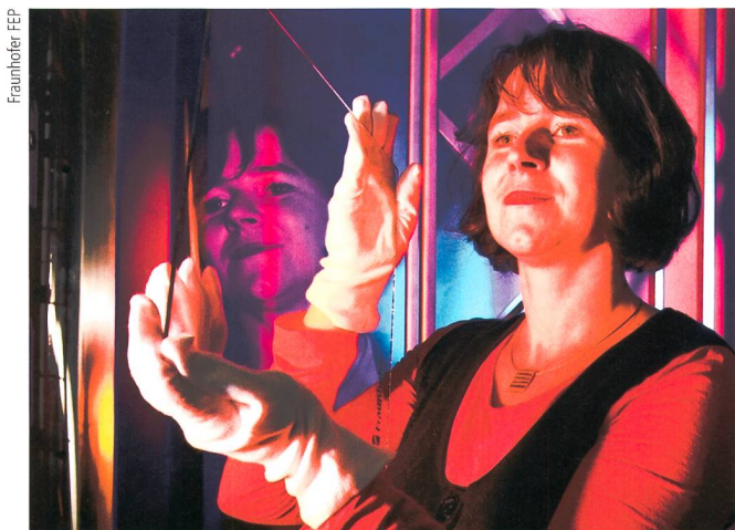
Eine Glasplatte mit einer transparenten, leitfähigen Titandioxid-Schicht.
