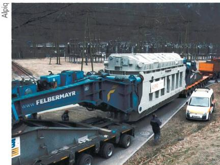
Der 186 t schwere, genau ans Tunnelprofil angepasste Lavorgo-Transformator beim Transport.
