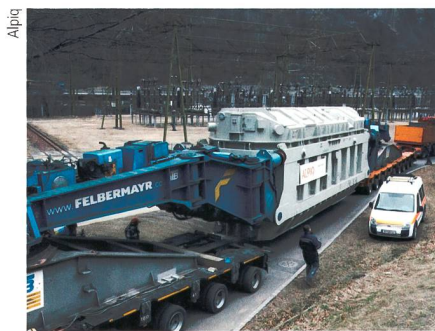
Der 186 t schwere, genau ans Tunnelprofil angepasste Lavorgo-Transformator beim Transport.
