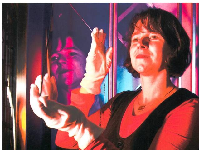
Eine Glasplatte mit einer transparenten, leitfähigen Titandioxid-Schicht.
