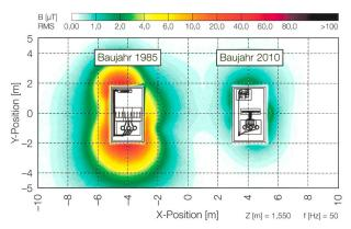
**Bild 3** Emissionsunterschied berechnet an einer Trafostation.
