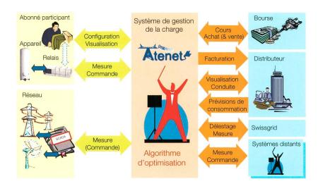
Figure 1 Les interfaces nécessaires au fonctionnement d'un système de gestion de la charge idéal.
