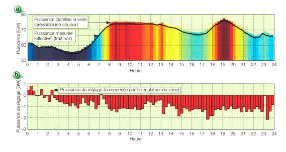
Figure 3 Bilans de puissance globaux en France sur 24 h (sources des données: RTE France [2]). (a) Comparaison de la puissance planifiée la veille et de la puissance mesurée le 17 janvier 2011. Les couleurs symbolisent le prix de l'énergie (bleu = bas, rouge = élevé). (b) Puissance de réglage, compensée par le régulateur de zone.
