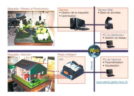
Figure 4 Structure du démonstrateur Atenet.
