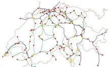
**Bild 5** Geografisches Modell des Schweizer Übertragungsnetzes (blau: 380-kV-Leitungen, grün: 220-kV-Leitungen, rote Punkte: Unterwerke, gelbe Punkte: Transformatoren; Elemente überdecken sich teilweise).
