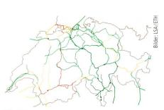
**Bild 7** Das relative Risiko der einzelnen Netzelemente (Leitungen, Transformatoren) aufgrund von Erdbeben (aufsteigend mit: dunkelgrün, hellgrün, orange, rot).
