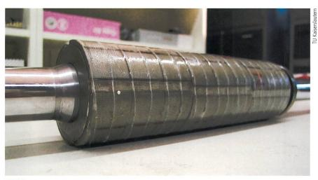
Bild 5 Läufer des Funktionsmusters mit Bandage.
