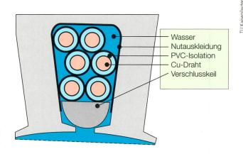
Bild 2 Prinzipdarstellung einer wasserbenetzten Ständernut mit PVC-isolierten Wickeldrähten.
