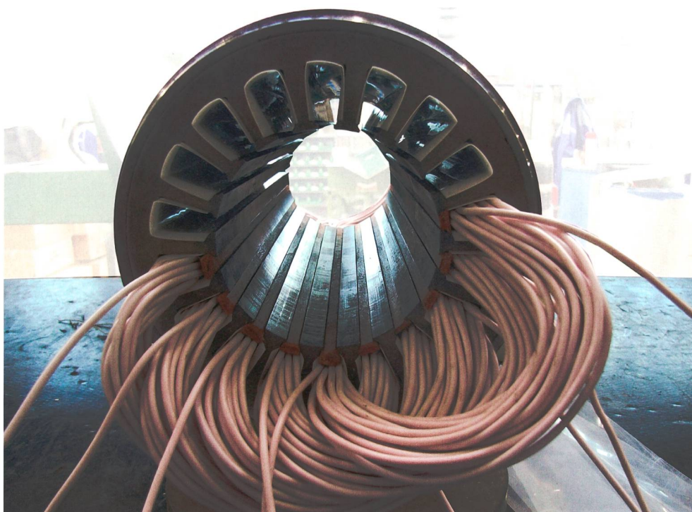
Bild 4 Ständerblechpaket des Funktionsmusters, teilweise bewickelt.
