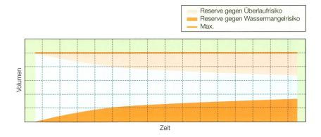
Bild 5 Beckenvolumen mit Reserve gegen Überlaufrisiko und Wassermangelrisiko mit 99 % Sicher-
