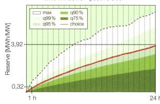
**Bild 4** Energiereserve pro MW für ein Wochenband und 95 % Sicherheit für die Lieferung von Regelenergie.
