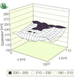
Figure 4 (a) Uniformité d'une couche de i:a-Si déposée dans le réacteur hérité d'UNAXIS en 2003. (b) Uniformité (±9 %) de l'épaisseur d'une couche de silicium microcristallin intrinsèque i:µc-Si déposée à 5,5 Å/s dans un réacteur PECVD récent de 1,4 m².
