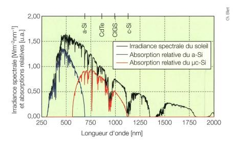
**Figure 1** Spectre du soleil, de l'ultraviolet à l'infrarouge, et absorptions relatives (en unités arbitraires) du silicium amorphe et microcristallin qui composent une cellule tandem micromorphe. Les longueurs d'onde correspondant aux gaps des quatre principaux matériaux PV utilisés pour la production de cellules solaires sont indiquées en haut de la figure.
