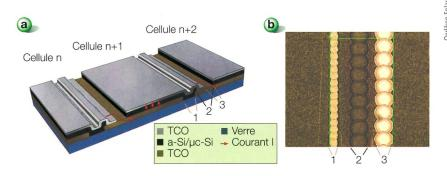
**Figure 3** (a) Vue tridimensionnelle de la mise en série des cellules d'un module grâce à la structuration laser. Le courant / circule du contact arrière (TCO gris) de la cellule n au contact avant (TCO beige) de la cellule n+1, traverse la cellule n+1 jusqu'au contact arrière (gris), et ainsi de suite. (b) Les trois traces du laser pulsé utilisé pour séparer les cellules individuelles afin d'assurer leur montage en série.
