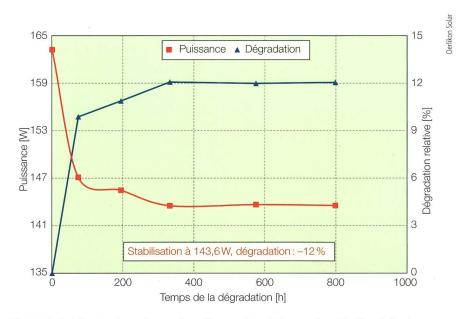
**Figure 7** Stabilisation du rendement du meilleur module « Micromorph » d'Oerlikon Solar. Avec une performance initiale de 163,2 W sous irradiance AM1,5 (rendement initial 11,1 %) et une performance stabilisée de 143,6 W déjà atteinte après moins de 400 h, ce module atteint un rendement stabilisé de plus de 10 % sur la totalité de sa surface (1,4 m²).
