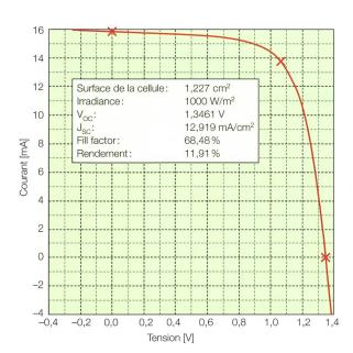
Figure 6 Meilleure cellule (surface env. 1,2 cm²) produite dans la section Oerlikon Solar-Lab à Neuchâtel. Elle présente un rendement stabilisé de 11,9 % — valeur confirmée indépendamment par le National Renewable Energy Laboratory (NREL), USA.
