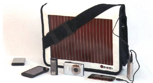
Bild 3 Umhängetasche mit Solarpanel (organische Fotovoltaik).
