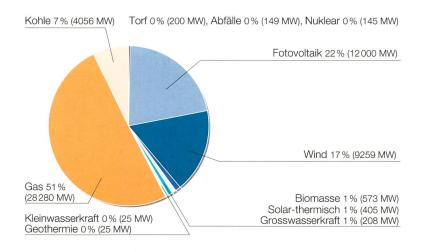
**Bild 1** Anteile an der neu installierten Leistung in der EU im Jahr 2010.
