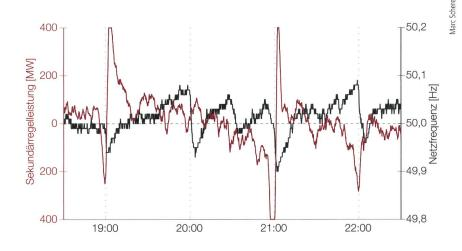
**Bild 2** Die Leistungs- und Frequenzeinbrüche aufgrund nicht konformer Fahrplanwechsel sind abhängig von den Marktteilnehmern.
