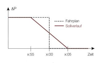
**Bild 1** Das Operation Handbook und der Transmission Code geben eine 10-minütige Rampe bei Fahrplanänderungen vor.
