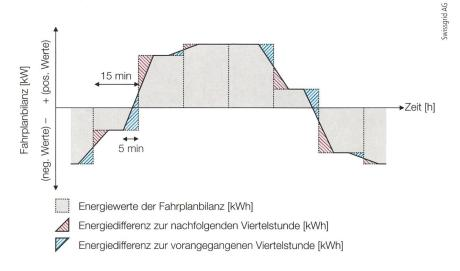
**Bild 3** Die Berechnung der Ausgleichsenergie berücksichtigt den Sollverlauf bei einer Fahrplanänderung. Fahrpläne für die Lieferung von Regelenergie sind davon nicht betroffen.
