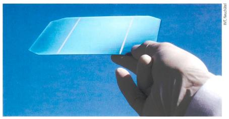
Figure 3 Cellule solaire à hétérojonction (silicium amorphe/silicium cristallin).
