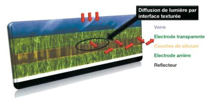
**Figure 1** Coupe transversale à travers une cellule micromorphe. Une cellule « micromorphe » peut comporter plus d'une dizaine de couches différentes. La cellule amorphe fait 200 nm d'épaisseur et la cellule microcristalline 1000–2000 nm.
