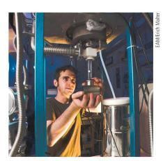
Eine Messapparatur zur Bestimmung von Defekten in Siliziumkarbid.
