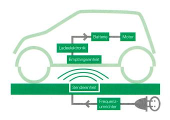
Bild 1 Prinzipskizze eines kontaktlosen Batterieladesystems.
