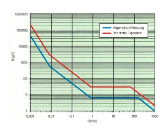
**Bild 3** Referenzwerte für Magnetfeldexpositionen gemäss den IC-NIRP-Guidelines.
