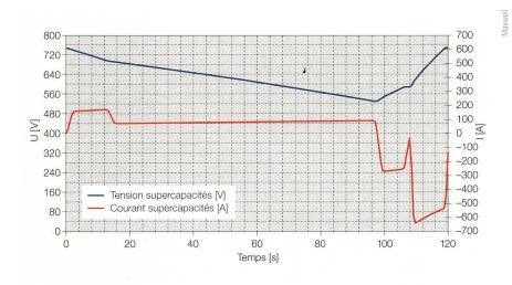
**Figure 4** Simulation du cycle de charge-décharge du BoostBus: capacité nominale de 41,3 F – 4 branches en parallèle de 16 modules de 165 F en série (total de 64 modules).
