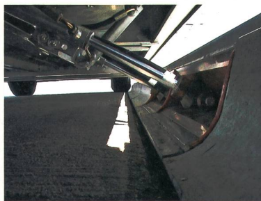
Figure 6 Couplage par bras articulé (a) et pantographe (b).
