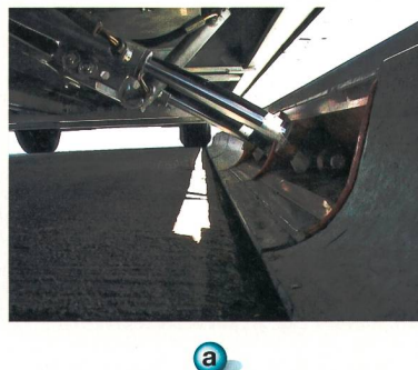
Figure 6 Couplage par bras articulé (a) et pantographe (b).
