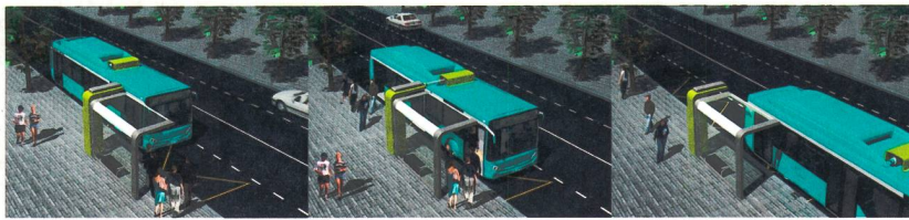
Figure 2 Couplage par bras articulé, tel qu'il est prévu dans le projet WATT.
