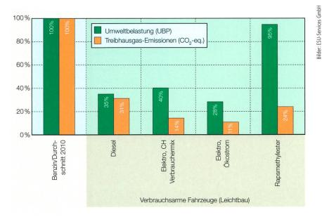
**Bild 5** Relativer Vergleich der Umweltbelastung (bewertet mit der Methode der ökologischen Knappheit 2006) und der Treibhausgas-Emissionen pro zurückgelegten Fahrzeugkilometer mit verbrauchsarmen Leichtbau-Fahrzeugen verschiedener Antriebssysteme und dem Flottendurchschnitt der Schweizer Dieselautos im Jahr 2010 als Referenz.
