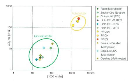
**Bild 1** Zweidimensionale logarithmische Darstellung von Kilometerleistung und Treibhausgas-Emissionen pro Hektar von Agrotreibstoffen verschiedener Energiepflanzen und Elektromobilität mit Strom aus Fotovoltaik-Freiflächenanlagen. BTL steht für Biomass-to-Liquid Fuel, CUTEC, TUV und UET sind die Entwickler verschiedener BTL-Umwandlungstechnologien (die zurzeit noch nicht auf dem Markt erhältlich sind), und FV steht für Fotovoltaik.
