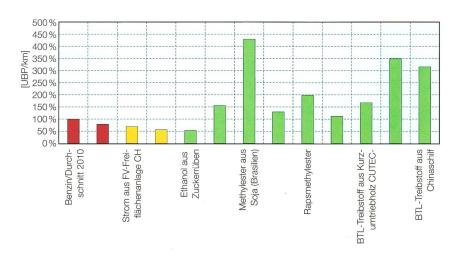
**Bild 3** Relativer Vergleich der Umweltbelastung (bewertet mit der Methode der ökologischen Knappheit 2006; UBP: Umweltbelastungspunkte) pro zurückgelegten Fahrzeugkilometer mit Fahrzeugen verschiedener Antriebssysteme und dem Flottendurchschnitt der Schweizer Benzin- und Dieselautos im Jahr 2010 als Referenz.
