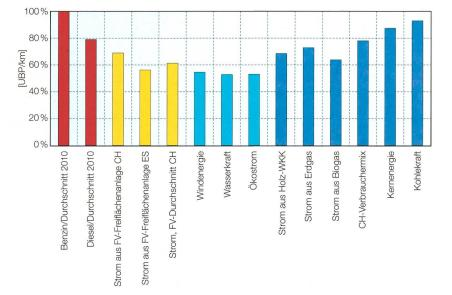
**Bild 4** Relativer Vergleich der Umweltbelastung (bewertet mit der Methode der ökologischen Knappheit 2006; UBP: Umweltbelastungspunkte) pro zurückgelegten Fahrzeugkilometer mit Elektrofahrzeugen in Abhängigkeit vom gewählten Stromprodukt sowie dem Flottendurchschnitt der Schweizer Benzin- und Dieselautos im Jahr 2010 als Referenz.
