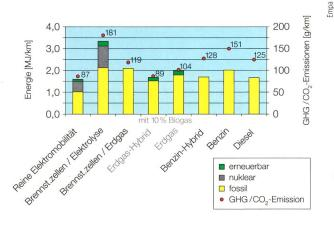
**Bild 5** Spezifischer Energieverbrauch und Treibhausgasemission verschiedener Antriebe.
