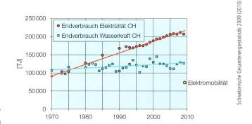
**Bild 3** Schweizer Elektrizitätsverbrauch und Wasserkraft.
