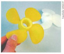
Dieser Propeller wurde bei 90 °C und 200 bar in nur 5 Minuten gelb gefärbt.
