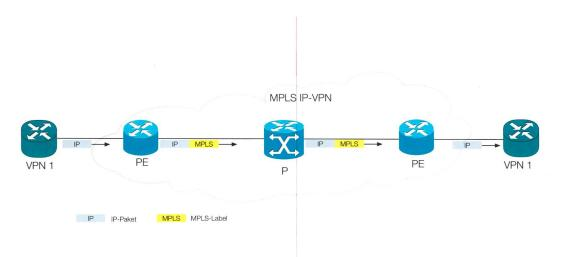
**Bild 2** Funktion: IP-Datagramme werden am Ingress-Router (links) mit einem MPLS-Label versehen, das am Egress-Router (rechts) wieder entfernt wird.
