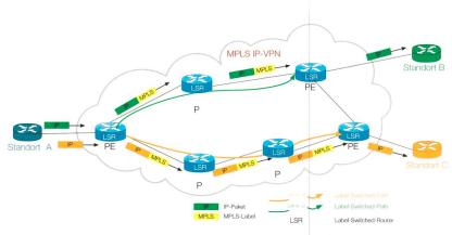
**Bild 3** Der Label Switched Path (LSP) ergibt sich aus der CE-CE-Strecke über den Label Switched Router (LSR).
