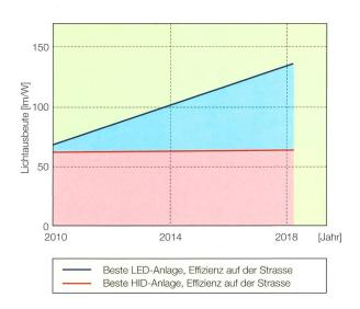
Bild 1 Effizienzvergleich zwischen HID und LED: Prognose für die Entwicklung der Lichtausbeute.
