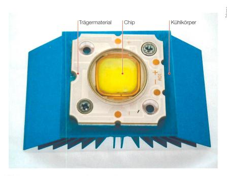
Bild 1 10-W-Power-LED montiert auf Lamellen-Kühlkörper mit 1,3 K/W.
