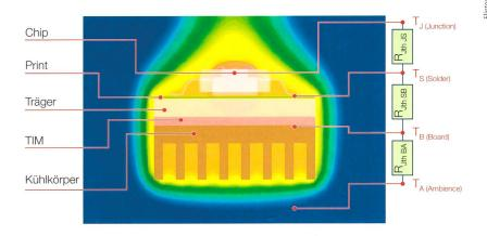
Bild 3 Thermisches Ersatzschaltbild einer LED mit Kühlkörper.
