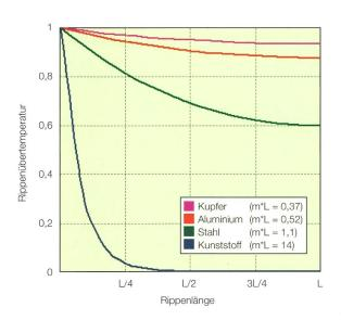
**Bild 5** Wärmeleitfähigkeit verschiedener Materialien.
