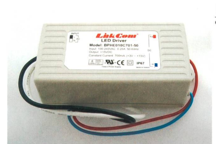
Bild 2 700-mA-Konstantstromversorgung für 10-W-LED.
