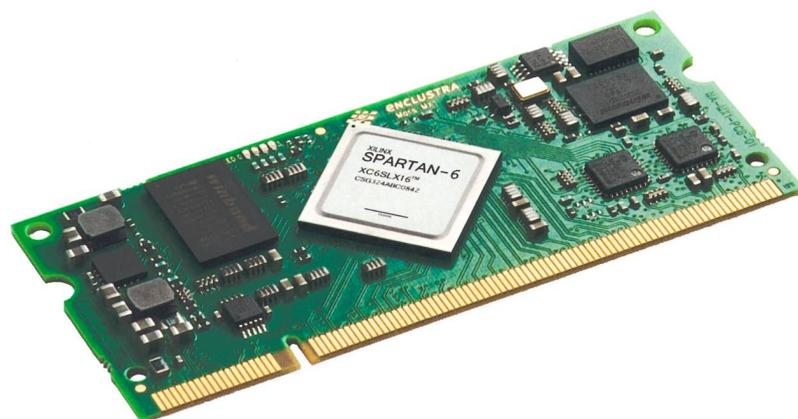
**Bild 3** Kostengünstiger Spartan-6-FPGA für Demonstrator.
