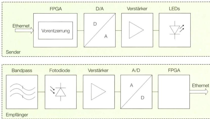
**Bild 1** Blockschaltbild Sender (oben) und Empfänger (unten).
