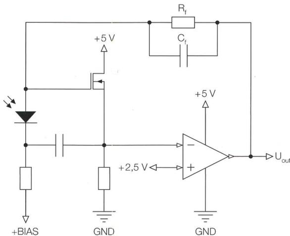
Bild 5 Schema Empfangsverstärker.
