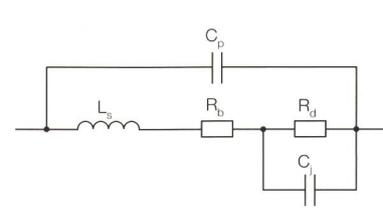
**Bild 2** Ersatzschaltung einer LED.
