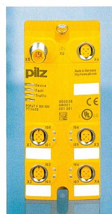
Digitale Eingangsmodule für das Steuerungssystem PNOZmulti. PNOZmulti anschliessen. Die digitalen Eingangsmodule ermöglichen es, kontaktbehaftete sowie elektronische Sensoren mit PLe nach EN ISO 13849-1 und SIL 3 nach EN/IEC 62061 ausserhalb des Schaltschranks anzuschliessen. Die Plausibilitätsprüfung wird vom Gerät übernommen. Die Kommunikation erfolgt über eine sichere Datenverbindung.
