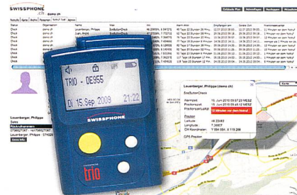
Swissphone Trio ist ein Alarmierungsterminal für Personen in riskoreichem Einsatz.
