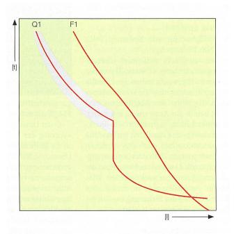
**Bild 3** Vgl. Charakteristik gl/gG-Sicherung (F1) zu Leitungsschutzschalter (O1)
