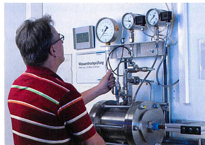
Druckprüfung zur Ermittlung des IP-Schutzes.
