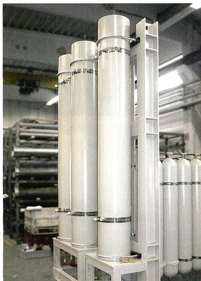
Sonocontrol 14 von aussen platzsparend am Kolbenspeicher montiert.
