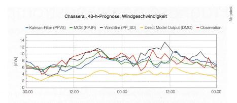
Darstellung aller Prognosemodelle an der Messstation Chasseral. Dank der Verfeinerung liegen Kalman-Filter, MOS und WindSim näher an der gemessenen Windgeschwindigkeit (rot) als die direkte Cosmo-Prognose (DMO, orange).
