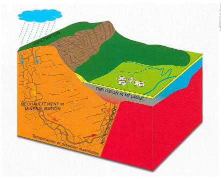
Figure 3 Circulation d'eau dans un aquifère profond.
