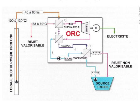
**Figure 1** Schéma simplifié du fonctionnement d'un forage géothermique profond et du module ORC pour la production d'électricité.
