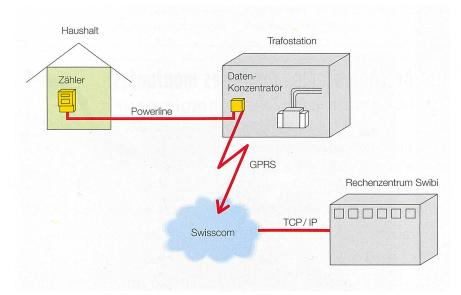
Per Powerline-Kommunikation werden die Haushaltzähler ausgelesen. Für die Verbindung ins Rechenzentrum von Swibi wird die drahtlose GPRS-Kommunikation genutzt.
