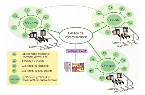
Figure 1 Le concept de contrôle décentralisé du projet « AuRA-NMS ».
