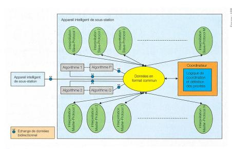
Figure 4 L'architecture d'un contrôleur « AuRA-NMS » incluant la logique de coordination.
