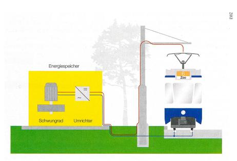
Prinzip eines stationär aufgestellten Schwungradenergiespeichers.
