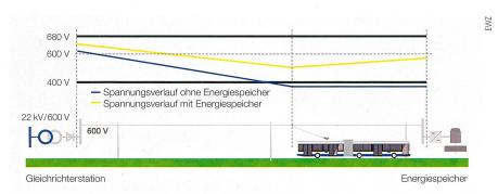
Prinzip der Spannungsstabilisierung mit einem Energiespeicher.
