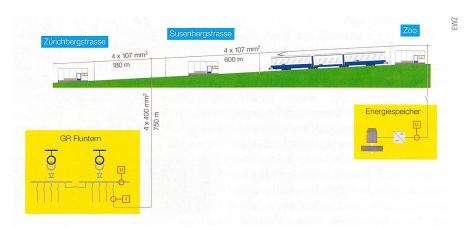
Streckenprofil der Versuchsstrecke.
