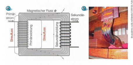
Bild 3 Beanspruchung durch das magnetische Feld.
