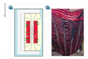
**Bild 4** Wicklungsbeanspruchung durch mechanische Kräfte.
