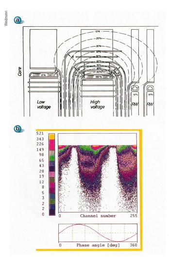
Bild 2 Beanspruchung durch das elektrische Feld. (a) Isolationssystem eines Transformators (H.P. Moser, Transformerboard, Weidmann). (b) Typisches Teilentladungsmuster (TE-Muster) für lokale Feuchtigkeit (Resultat einer Vor-Ort-TE-Messung, 400 MVA, 400/220/16-
