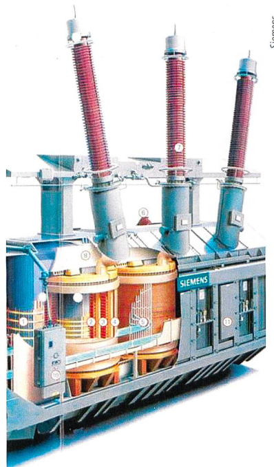
Bild 1 Aktivteil eines Leistungstransformators.
