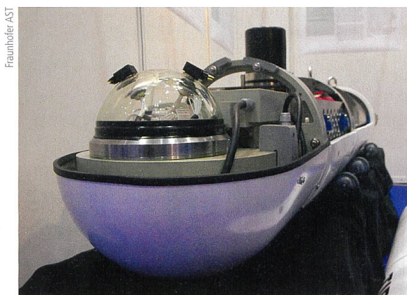
Le robot sous-marin en forme de torpille sera conçu pour atteindre des profondeurs de 6000 m.
