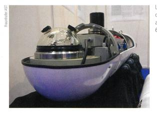
Le robot sous-marin en forme de torpille sera concu pour atteindre des profondeurs de 6000 m.
