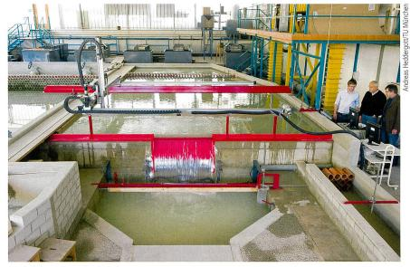
Modell des Schachtkraftwerks.
