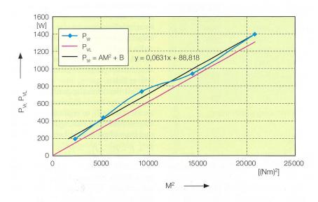
**Bild 3** Näherung der Restverluste über die abgegebene mechanische Leistung im Verhältnis zur Maschinenbemessungsleistung.
