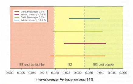
Bild 7 Auswirkung der Messgeräte-Genauigkeitsklasse auf das 95%-Vertrauensintervall.
