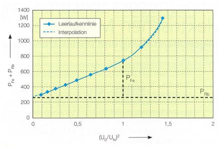
**Bild 2** Leerlaufkennlinie einer Maschine, Bemessungsleistung 30 kW.
