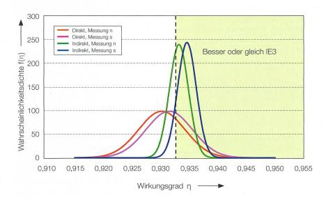
**Bild 5** Darstellung des Ergebnisses der Wirkungsgradbestimmungen in Form der Verteilungsdichte-
