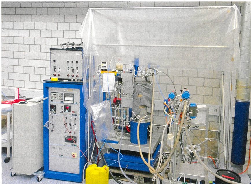
Bild 4 Die Labor-MBR-Anlage. Auf dem Bild rechts ist die UF und links davon der Biogas-Reaktor zu sehen. Ganz links ist die Steuerung zu erkennen. Mit der Anlage an der ZHAW Wädenswil werden Fragen der Biologie und des Abbauprozesses untersucht.
