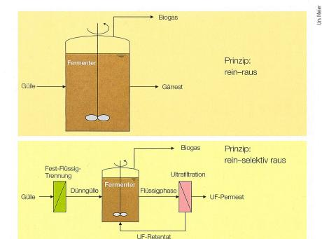
**Bild 1** Vereinfachtes Schema der konventionellen Vergärung (oben) und des Membran-Bio-Reaktors MBR (unten). Die wichtigsten Merkmale beim MBR sind die Ultrafiltrationsstufe sowie die Vorbehandlung der Rohgülle.
