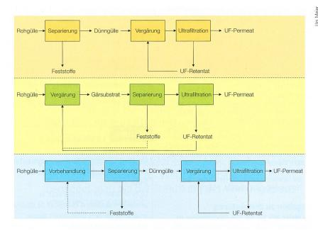
**Bild 5** Konzepte zur Implementierung des MBR-Systems. Die grosse Flexibilität des MBR-Verfahrens ermöglicht es, unterschiedliche Lösungen anbieten zu können. Zudem kann die MBR-Technologie ideal mit neuen Prozessstufen, wie eine Desintegration als Vorbehandlung, kombiniert werden.
