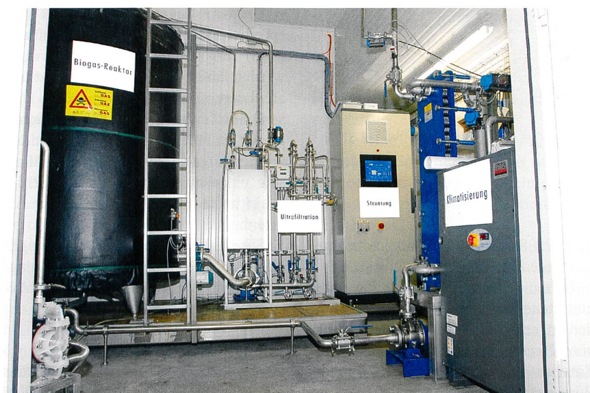
Bild 3 Ansicht der halbtechnischen MBR-Versuchsanlage. Zur Sicherstellung eines problemlosen Betriebs auch in den Wintermonaten ist die Anlage in einem isolierten Gebäude untergebracht.
