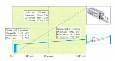
Bild 2 Kostenvergleich Pneumatik (grau) – Elektromechanik (hellblau).
