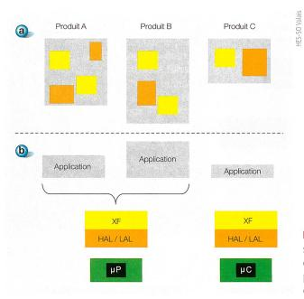
**Figure 6** Produits sans architecture (a) en comparaison avec des produits à architecture commune (b).
