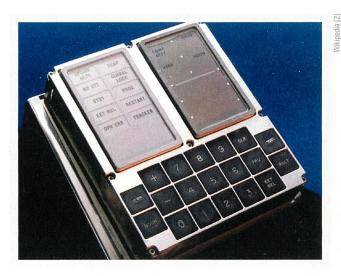
**Figure 2** L'interface utilisateur de l'AGC (Apollo Guidance Computer).
