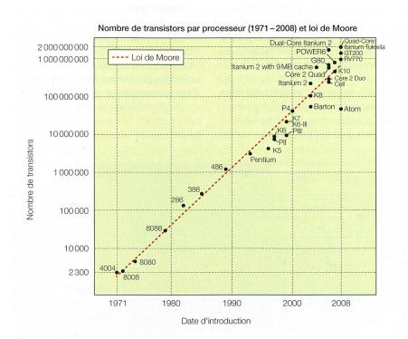
Figure 1 L'évolution des processeurs Intel.
