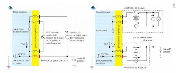
**Figure 2** La technologie utilisée dans Sense pour mesurer l'ECG et l'impédance transthoracique est équivalente à l'approche classique à 4 fils, mais ne nécessite qu'une seule connexion galvanique entre les « électrodes-capteurs », ce qui simplifie considérablement la connectique avec le vêtement. (a) Approche classique à 4 fils (utilisée dans LTMS). (b) Approche Sense à « fil » unique (brevet déposé).
