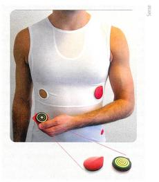
**Figure 4** T-shirt et capteurs de Sense (modèle pour la course à pied) mesurant chez les sportifs, pendant l'effort et en récupération, ECG, pouls, variabilité cardiaque, respiration, activité, cadence, vitesse, altitude et températures (de peau et ambiante).
