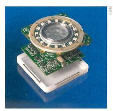
**Figure 3** « Electrode-capteur » qui, placée sur le haut du sternum, mesure simultanément une dérivation ECG, la S<sub>p</sub>O<sub>2</sub>, la température corporelle et l'activité/posture du sujet.
