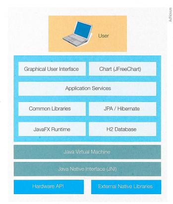
**Figure 5** Architecture technique du logiciel Sense d'AdNovum reposant sur JavaFX.
