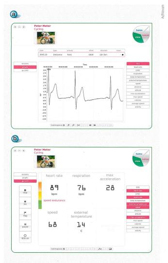
**Figure 6** Deux exemples de « pages » typiques, telles que les présente le logiciel de Sense. (a) Affichage de signaux physiologiques comme l'ECG. (b) Visualisation en temps réel des paramètres physiologiques du sportif.
