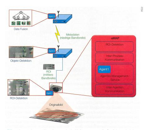
**Bild 4** Schematische Darstellung der eMAP (Embedded-Management-Plattform), beispielhaft für die HW-Plattform einer Smart-Kamera (Details siehe Text).
