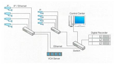
Bild 2 State-of-the-Art-Videoüberwachungssystem mit zentralisierter VCA.
