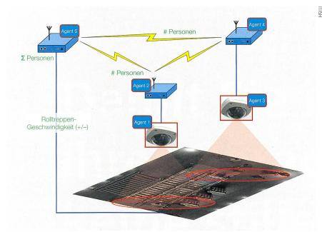
**Bild 5** Demoapplikation des agentenbasierten IMSN zur intelligenten Kontrolle einer Rolltreppenansteuerung. Mittels zweier Kameras wird der Personendurchsatz am oberen und am unteren Ende bestimmt und die Rolltreppengeschwindigkeit dynamisch an das Passagieraufkommen angepasst. Foto mit freundlicher Genehmigung der Flughafen Zürich AG zur Verfügung gestellt.
