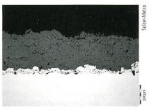
**Bild 1** Querschliffbild thermisch gespritzter Beschichtungen (Haftschicht Mitte, Deckschicht oben) auf einer Stahlunterlage (unten).
