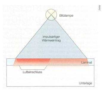
raum angeordneten Strahlungsdetektors, kann als Mass für die Schichtdicke benutzt werden.
