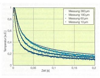
**Bild 3** Typische Messkurven für Beschichtungen unterschiedlicher Dicke.
