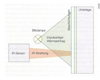
**Bild 2** Das Schichtsystem wird mit einer Blitzlampe erwärmt und die Oberflächentemperatur mit einem Infrarotsensor gemessen.
