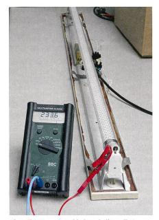
Choc électrique possible lors de l'installation/ encliquetage d'un côté d'un tube LED.
