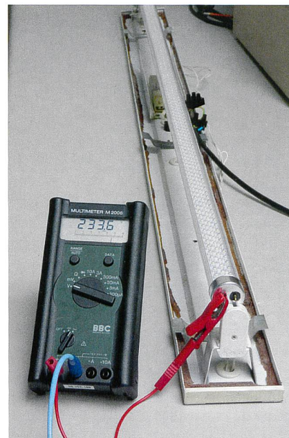
Folgorazione elettrica possibile in caso di introduzione/innesto in posizione su un solo lato di un tubo LED.
