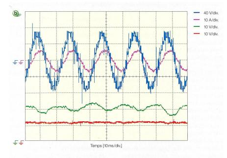
Figure 8 (a) Les résultats de simulation. (b) Les résultats du prototype basse tension (bleu: tension, violet: courant, vert: tension du condensateur d'une phase, rouge: tension du condensateur du PEBB).
