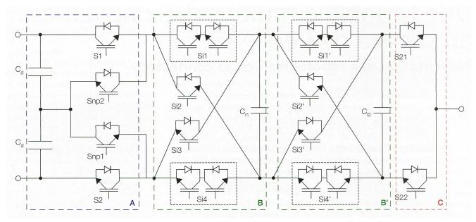
Figure 3 Forme générale du convertisseur « Cross Connected Intermediate Level VSI », ici avec 2 étages cascadés (B et B').
