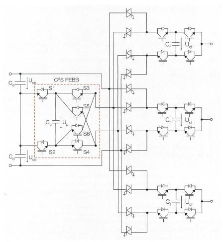
**Figure 6** Convertisseur « Common Cross Connected Stage VSI » à 9 niveaux. La cellule fondamentale, le « Common Cross Connected Stage Power Electrical Building Block » (C<sup>3</sup>S PEBB), se trouve en amont du convertisseur triphasé.
