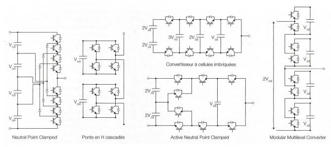
Figure 2 Aperçu de quelques topologies « classiques » à 5 niveaux de sortie. De gauche à droite : le NPC [1], les «ponts en H cascadés», le convertisseur à cellules imbriquées [4], l'ANPC [2] et le M²LC (Modular Multilevel Converter) [3].
