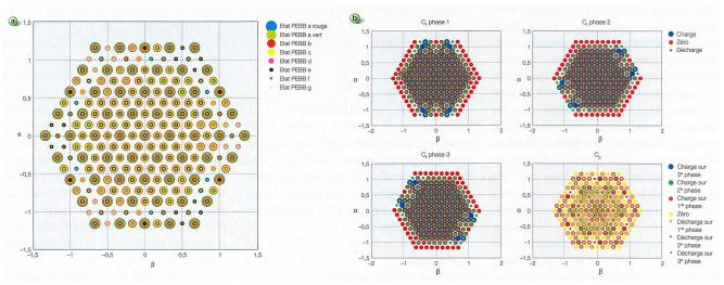
Figure 7 Modèle graphique par phaseurs spatiaux. (a) Les états de commutation de la cellule « cross connected » et les phaseurs atteignables. (b) Les actions possibles sur les condensateurs en fonction des phaseurs.
