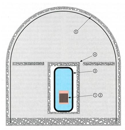
**Bild 2** Schematische Darstellung der verschiedeneren Schutzbarrieren eines heutigen Kernreaktors. 1: Brennstoff in Keramikform, 2: gasdicht verschweisste Hüllrohre der Brennstäbe,
