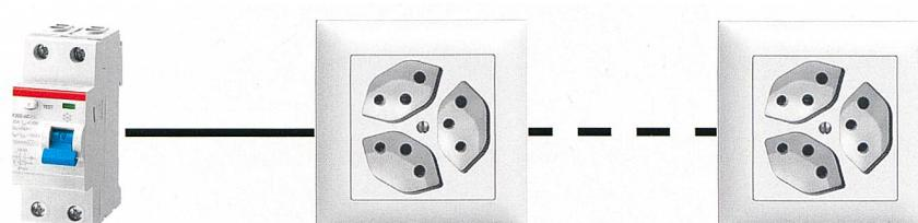
RCD nel quadro secondario in caso di ampliamento nel sistema TN-S.
