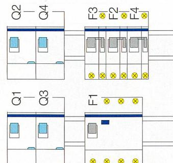
Q1 – Q4: Leitungsschutzschalter mit RCD
