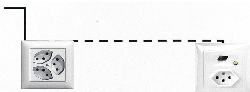
Ampliamento in caso di messa al neutro secondo lo schema III (sistema TN-C).
