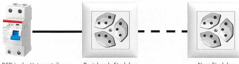
RCD in der Unterverteilung bei einer Erweiterung im System TN-S.
