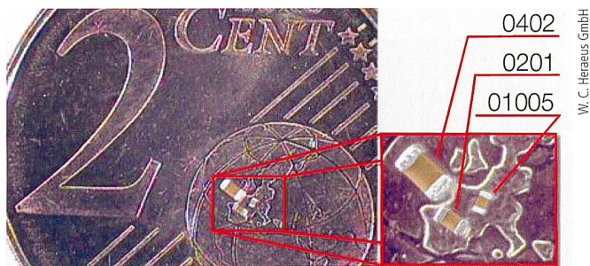
Bild 2 In der Elektronikfertigung gebräuchliche Komponenten.
