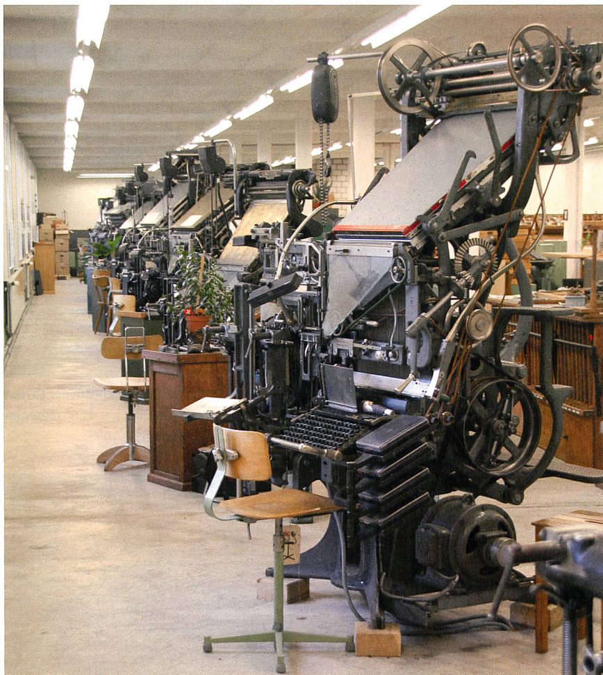
Bleisetzmaschinen – erfunden im späten 19. Jahrhundert – lieferten die grossen Textmengen für Zeitungen und Zeitschriften. Im Typorama Bischofszell (Bild) stehen Modelle ab Baujahr 1912 bis zu den letzten Modellen aus den 1980er-Jahren. So oder ähnlich wie auf diesem Foto sah es zurzeit der Bulletin-Gründung im Jahre 1910 in vielen grösseren Zeitungs- und Zeitschriftenbetrieben aus.
