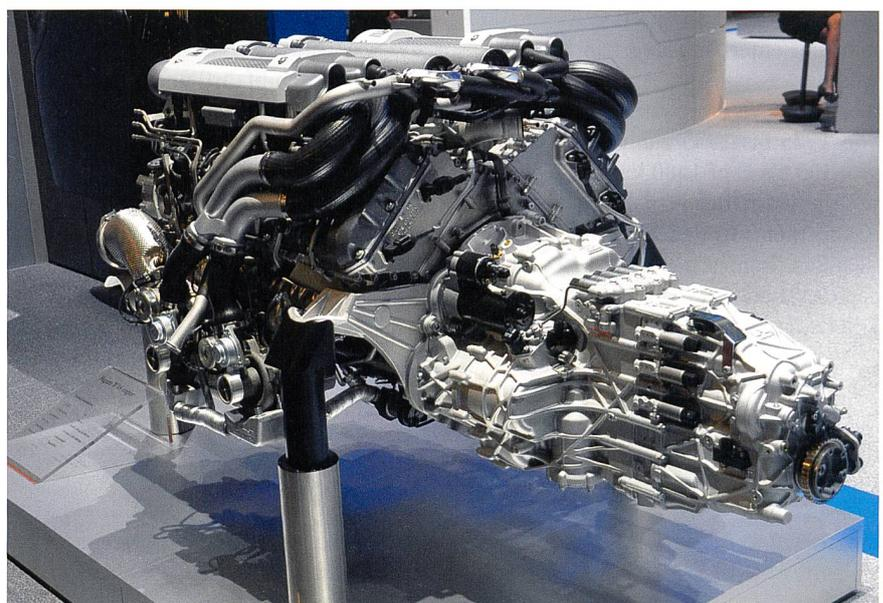
**Bild 6** Es gibt zahlreiche Möglichkeiten, um aus raffiniertem Erdöl mechanische Energie zu gewinnen. Eine noble, aber nicht ganz ökologische Variante ist die Verbrennung im Bugatti-W16-Motor (16 Zylinder, W-Anordnung), weltweit dem einzigen produzierten W16-Motor. Er liefert 1001 PS bei 6000 U/min.
