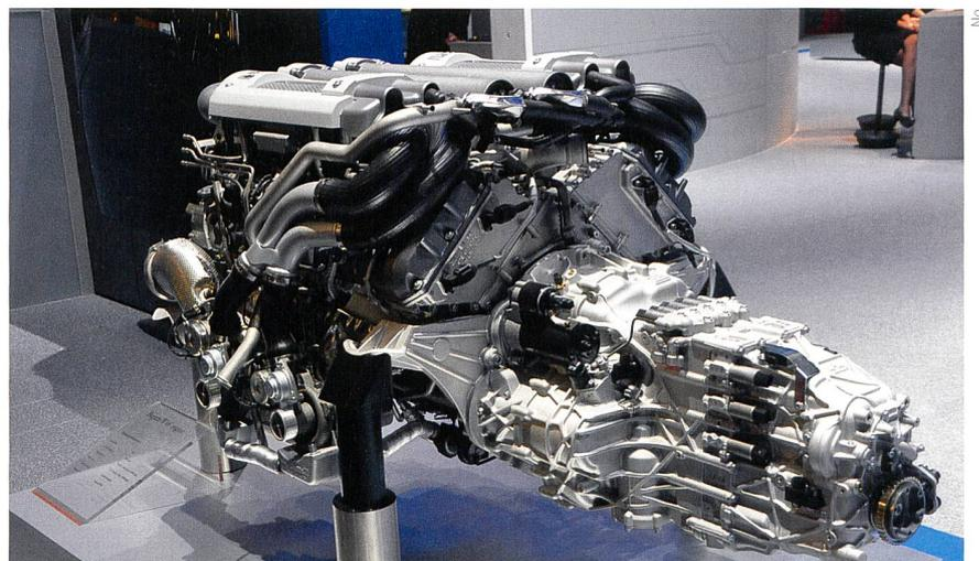
**Figure 6** Il existe de nombreuses possibilités de produire de l'énergie mécanique à partir de pétrole raffiné. Une variante noble quoique peu écologique est sa combustion dans un moteur Bugatti-W16 (16 cylindres en W), le seul moteur W16 fabriqué dans le monde. Il délivre 1001 ch à 6000 t/min.
