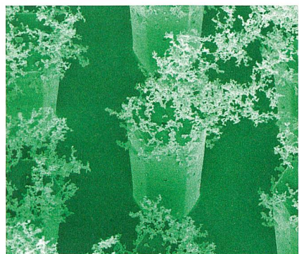
Exemple de nanodétecteurs : nanoparticules de carbone sur bâtonnets de prélèvement en silicium.
