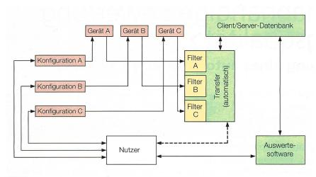
Bild 2 Prinzipieller Aufbau des Überwachungssystems.
