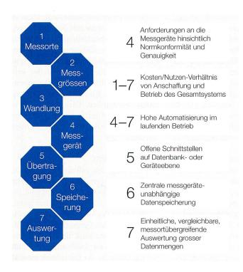
**Bild 1** Wichtige Kriterien bei der Konzeption eines Spannungsqualitäts-Überwachungssystems.
