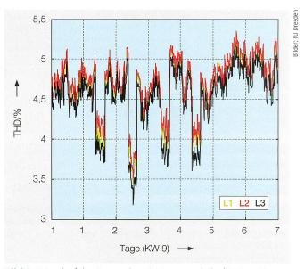
**Bild 6** Zeitverlauf des Gesamtoberschwingungsgehalts für einen Messort und eine Woche.
